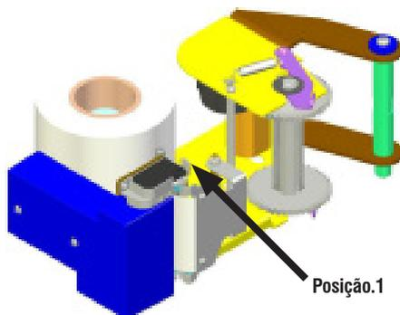
Passa a caneta transversalmente sobre a superfície da cabeça térmica.
