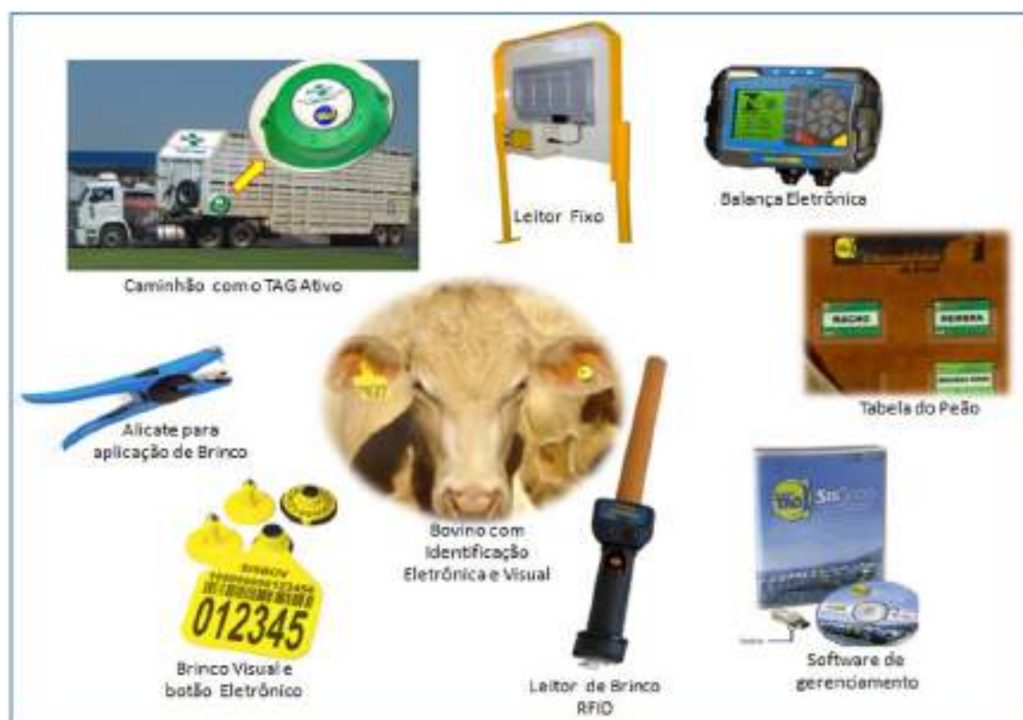
Figura 5. Foto do Tag Ativo acoplado ao caminhão de transporte de animais e os dispositivos eletrônicos para a identificação, gerenciamento e rastreabilidade bovina.
