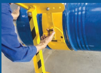
Travas de giro com Pinos para liberação e fixação do tambor.
